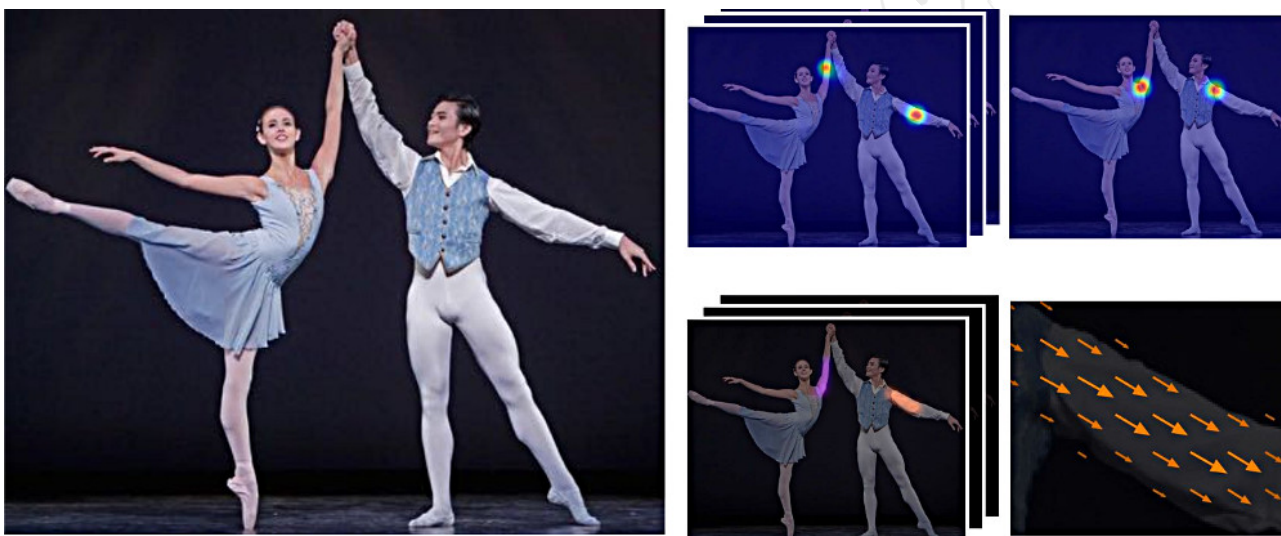
Slika 11.20: Primer ulazne slike (levo), mapa pouzdanosti za dve vrste zglobova (gore desno) i vektorskog polja koje definiše orijentaciju dela tela koji ih povezuje (dole desno).
